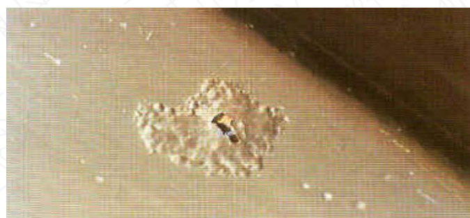
Slika 2: Nastanak mjehura radi prohrđavanja
