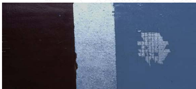
Slika 1: Primjer prionljivosti: Lijevo – specijalni premaz za zaštitu pocinčanog lima, desno – „klasičan“ univerzalni premaz
