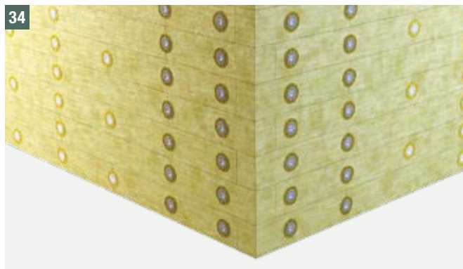
Shema pritrjevanja lamel MW (120×20 cm), površinsko 6 sider z robno cono 8 – slika 34
