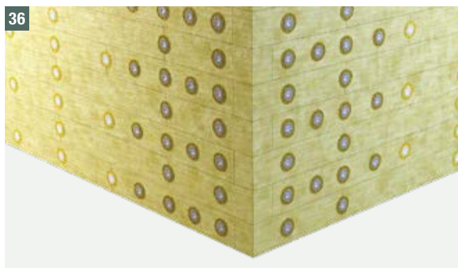
Shema pritrjevanja lamel MW (120×20 cm), površinsko 6 sider z robno cono 12 – slika 36
